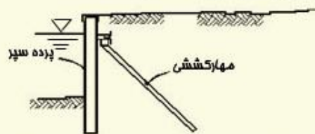
(ه) مه‌هارهای کششی از شمع‌های فلزی با مقطع H شکل
