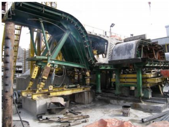
سیستم قالب بندی به کار رفته در ساخت قطعات
